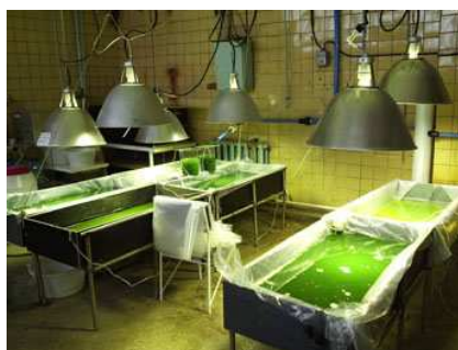
Рис. 2. Внешний вид экспериментальных установок, обеспечивающих заданные характеристики роста микроводорослей
